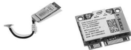
1. **Bluetooth<sup>136</sup> ausbauen.** In vielen neueren Laptops findet sich eine Karte, die sowohl das WLAN, als auch das Bluetooth-Modul beinhaltet (siehe Abbildung oben). Nach Lösen aller Schrauben des Laptop-Bodens und dem Abnehmen des Bodendeckels könnt ihr die beiden Antennenanschlüsse abziehen und die Karte(n) herausnehmen. Im Falle einer kombinierten Bluetooth/WLAN-Karte<sup>137</sup> müsst ihr diese durch eine WLAN-Karte ersetzen.
